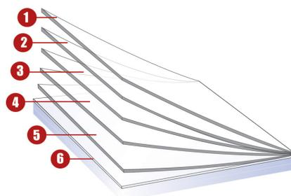
1. Couche «dure» résistantes aux rayures «courante», permettant une bonne durabilité et facilité d'entretien lors du nettoyage des vitres
