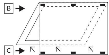
**C.** Otez le protecteur des scratches situés en bas et en tendant bien le film, appliquez celui-ci sur le châssis
